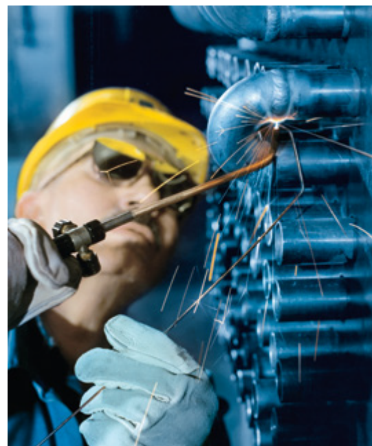
Gāzes metināšanas darbs siltummaiņa apstrādē.
