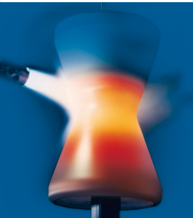
Metāla virsmas atjaunošana izmantojot metāla pulveri un acetilēna liesmu.
